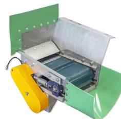
Kit tapis convoyeur gauche et droite pour égreneur, avec structure acier Inoxydable, 2 rouleaux en gomme, tapis en PVC et moteur hydraulique.
