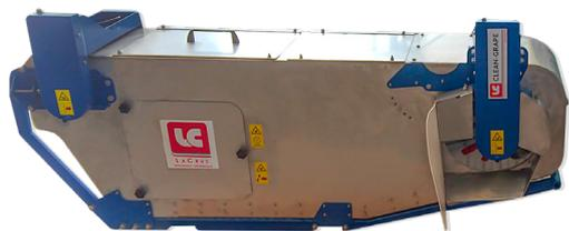
La chambre d'égrenage confine l'action du rotor évitant ainsi de broyer les feuilles et rafles le long de la chaîne de tri tout en les éliminant rapidement.
